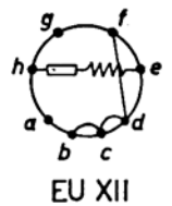
Links: Bild 11. Im Erregerstromkreis wird ein Widerstand benützt Bild 12. Die Sockelschaltungen von drei Eisen-Urdox-Widerständen
